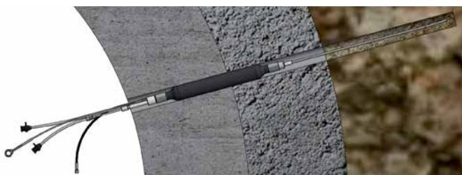
Gespannter Blähpacker mit Entlüftung vor der Injektion
